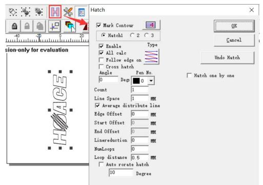
5. Menu bar-Laser-Rotate Text Mark-Set parameters
